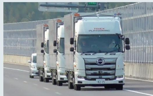
通过3台卡车进行后续无人队列行驶试行实验的情景
